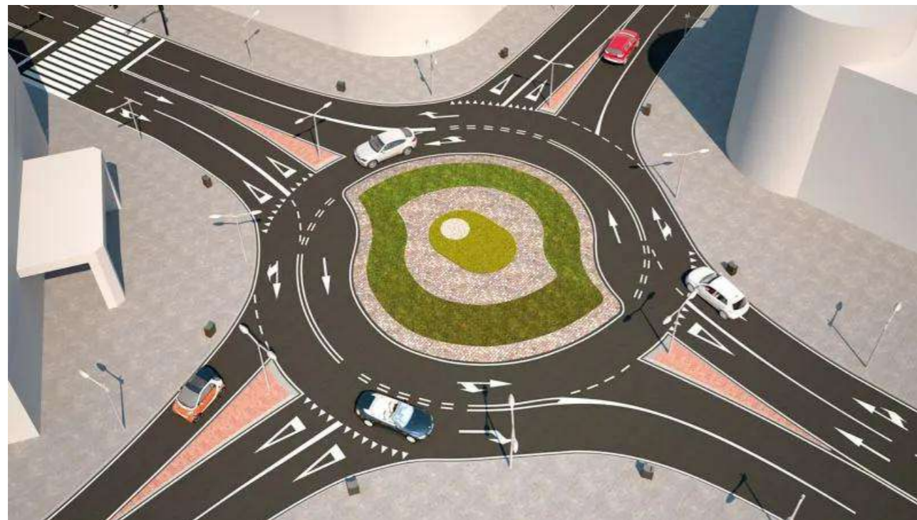
Figura 30. Ejemplo de intersección guiada para mejorar la fluidez circulatoria Fuente: Cesvimap
