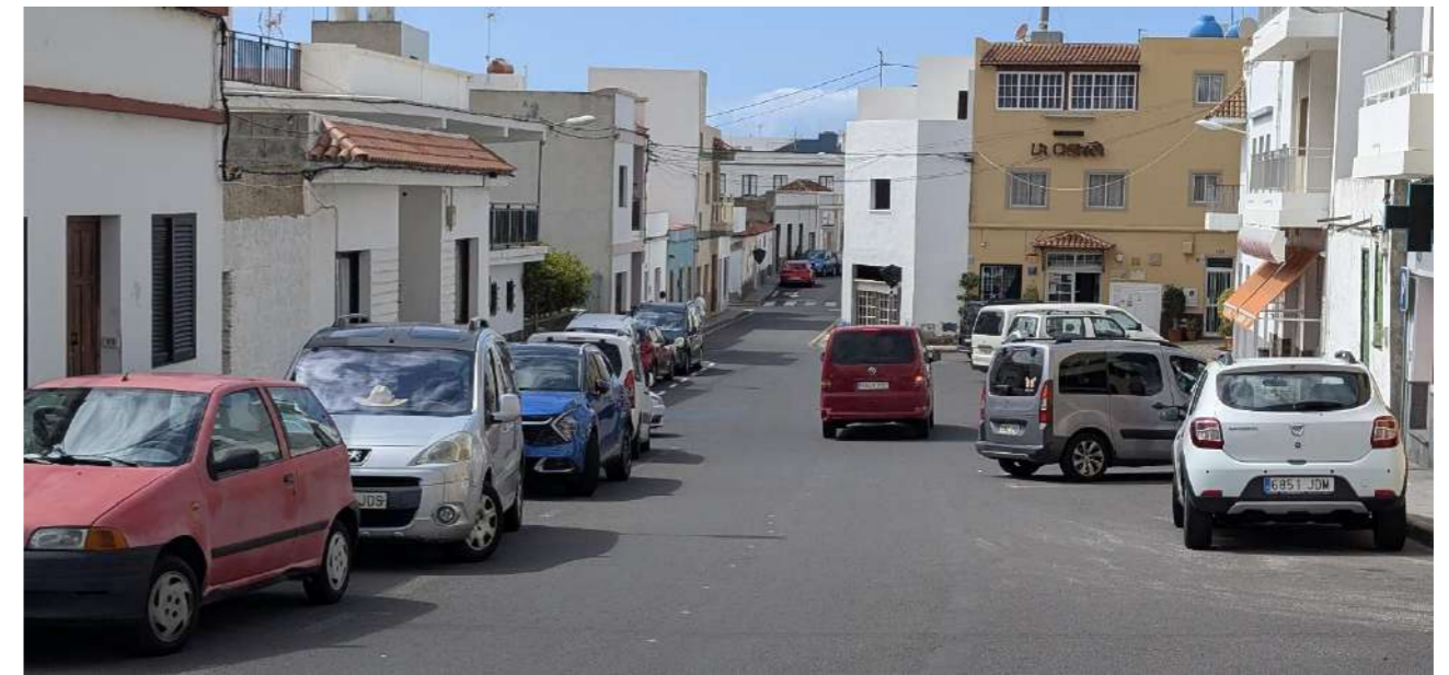
Figura 76. Ejemplo de aparcamiento con estrechamiento de vía de circulación en C/El Puerto Fuente: Elaboración propia
