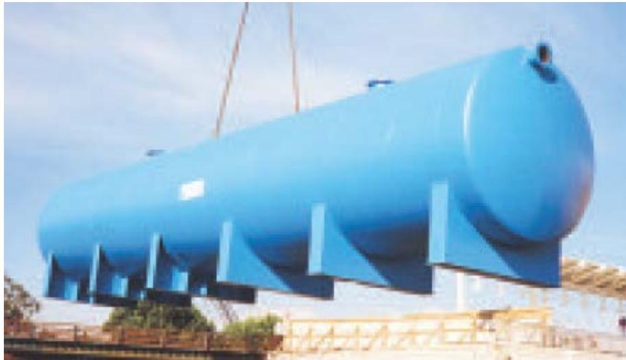
Ilustración 57 Tanque de almacenamiento de frío industrial. Fuente: Cristopia
