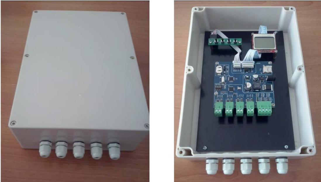
*Ilustración 51 Controlador de grupos de bombeo implementado en sistemas de bombeo de la isla de Tilos (Grecia)*
