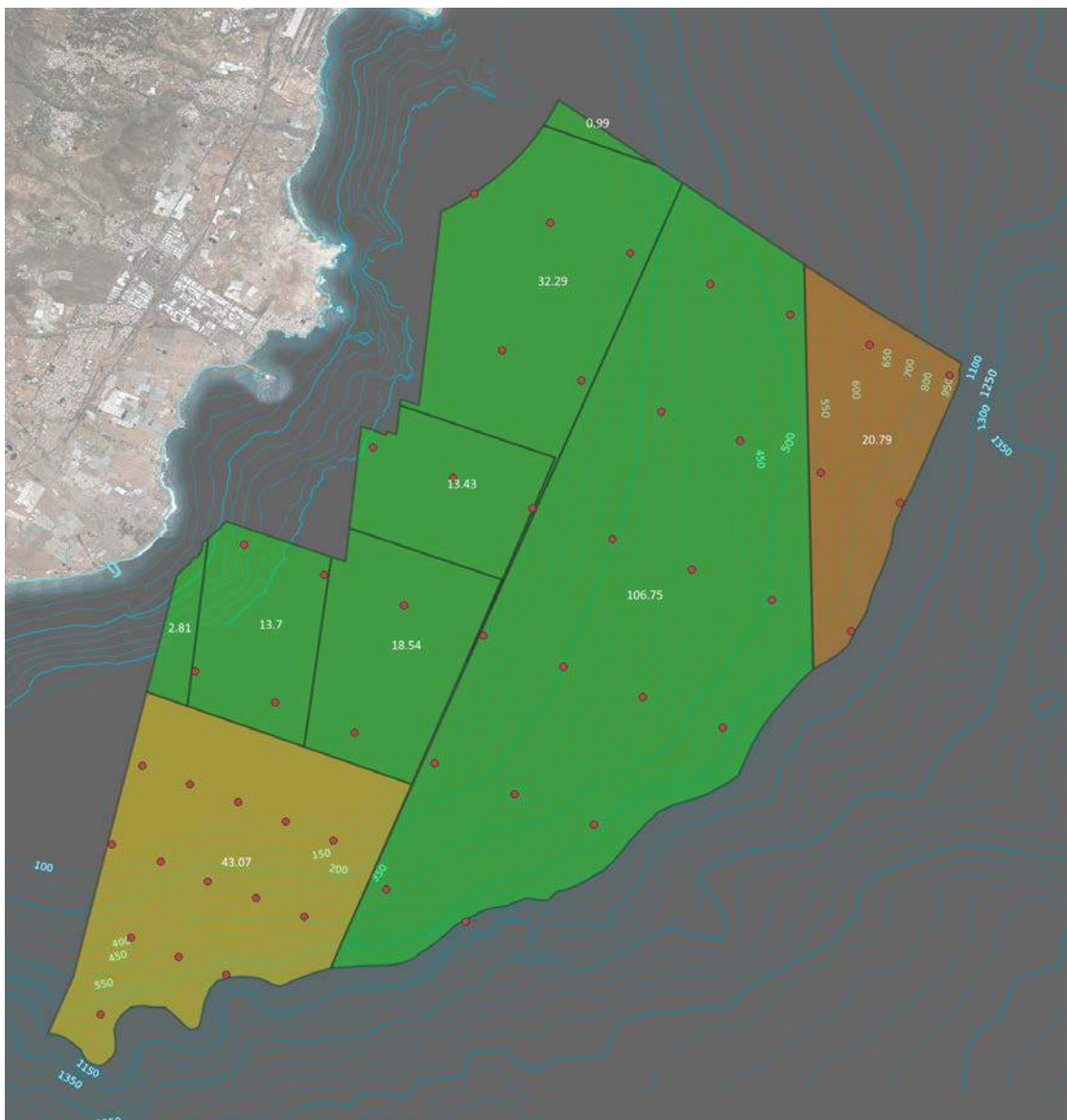
Figura 127 Distribución de aerogeneradores según criterio 16D/10D para la isla de Gran Canaria
