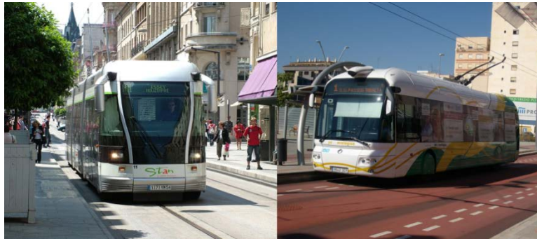
Figura 115 Trolebuses guiados mediante carril centrado y guía óptica
