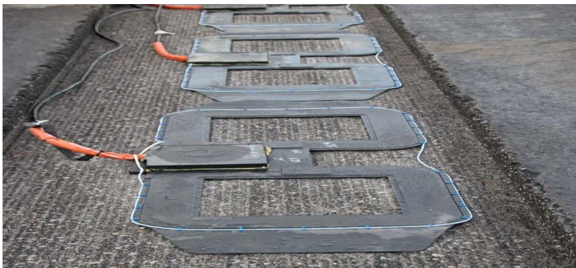
Figura 39 Sistema de recarga por inducción magnética
