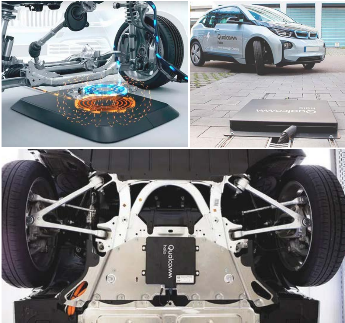
Figura 40 Modelo comercial de carga por inducción
