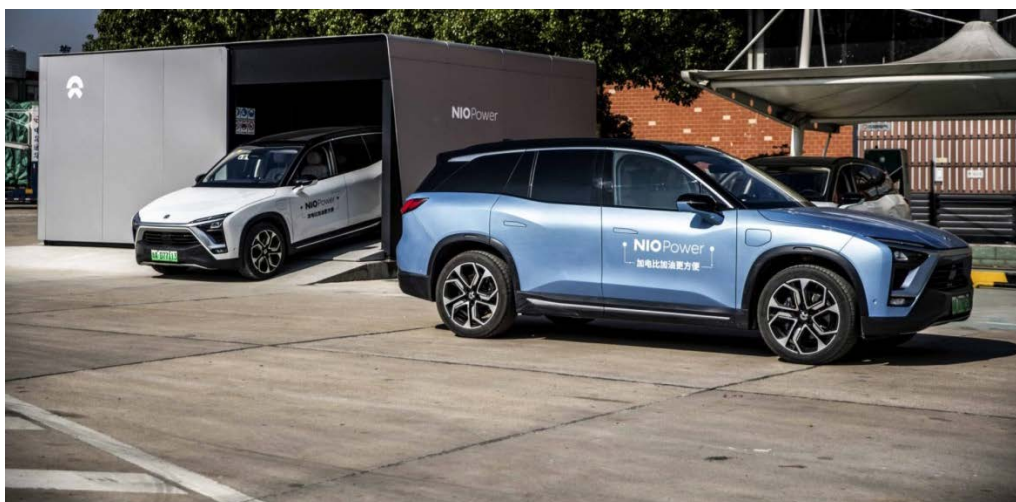
Figura 42 Sistema de cambio rápido de baterías
