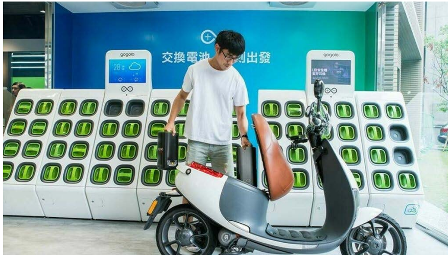
Figura 45 Cambio de baterías para moto Yamaha Gogoro
