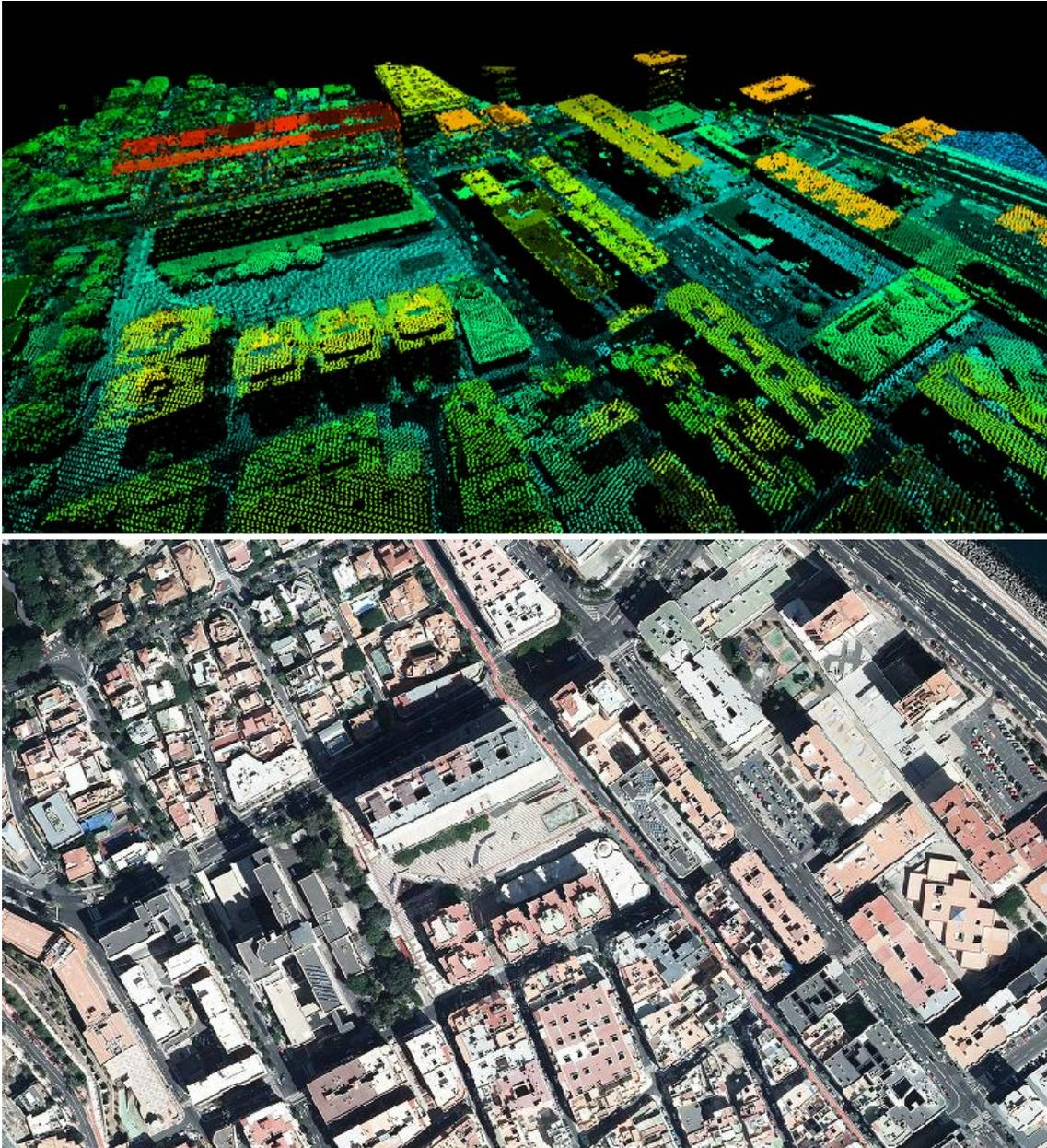
*Figura 4 Ejemplo datos LIDAR vistos en 3D con visor GRAFCAN*
